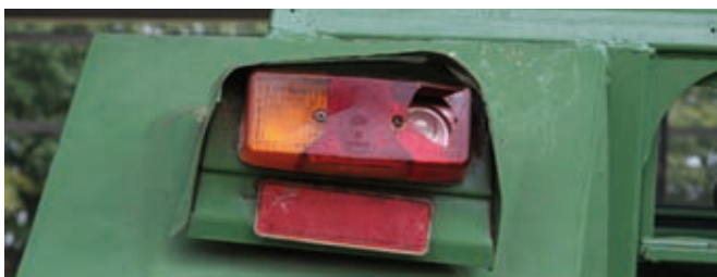
Schäden an der Beleuchtungsanlage
